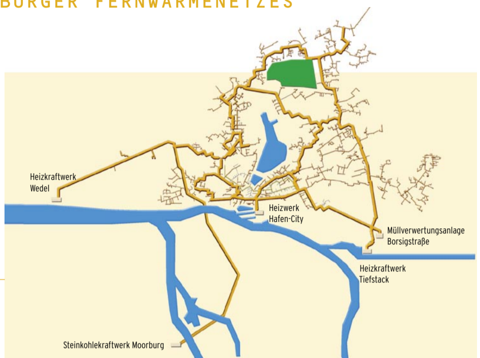
Kraftwerke und Fernwärmenetz in Hamburg
